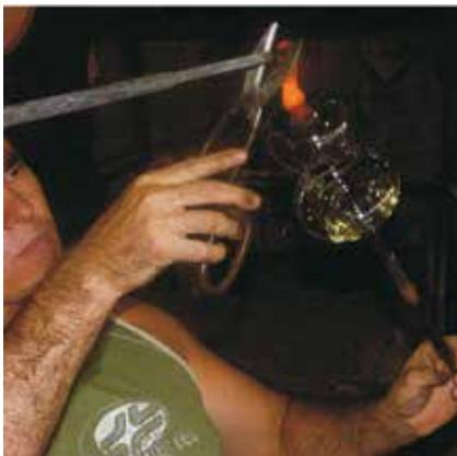
Die Schmelze für den Stiel wird angesetzt. Während nahe zu aller Arbeitsvorgänge wird die Pfeife gedreht.
